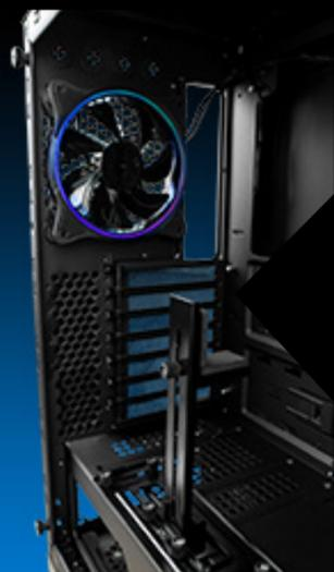
**Piensa en grande.** Su enorme capacidad te permite instalar tarjetas madre hasta E-ATX, tarjetas gráficas hasta 455 mm y disipadores de CPU hasta de 170 mm de altura. Además cuenta con un soporte para tarjetas de video que evita que se puedan pandear o dañar con el transporte.
